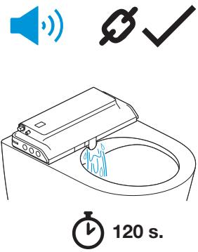
**ES** Desde el instante en que se enchufa el aparato a la red (2), se dispone de 60 segundos para sincronizar el mando. Para sincronizar el mando (3), presionar simultáneamente los botones Secado y Paro/Stop del mando durante 5 segundos hasta que se escuche un beep y se encienden todos los LED del mando. A partir de ese momento se inicia un proceso de auto-calibración del aparato (4) que dura 120 segundos, durante el cual sale agua por la ventana de la cánula del e-bidet.
